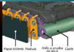
Estructura impermeable de triple capa
