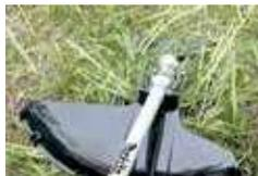
Los restos de césped se pueden retirar mediante una rotación lenta en sentido contrario a la rotación de corte. Después de 1.5 segundos, la máquina se detiene en la posición del interruptor volverá a la posición "Adelante" automáticamente después de detenerse.
