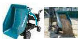
El volcador eléctrico está limitado a su uso en terreno plano, por lo tanto, la máquina está equipada con un indicador de nivel para comprobar la nivelación de la máquina.
