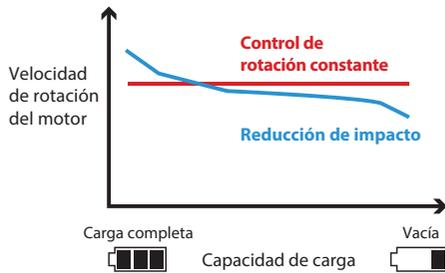
El dispositivo evita la disminución de rotación causada por un cambio de carga de la batería y modera la fluctuación de un apriete estable
