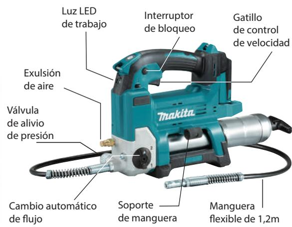
Capaz de dispensar grasa a una presión de 69MPa, para mantenimiento de maquinaria pesada, maquinaria agrícola u otra maquinaria de gran tamaño, como engrase, tensado de cadenas y más.
