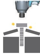
Deformación de la pieza, desplazamiento del agujero
